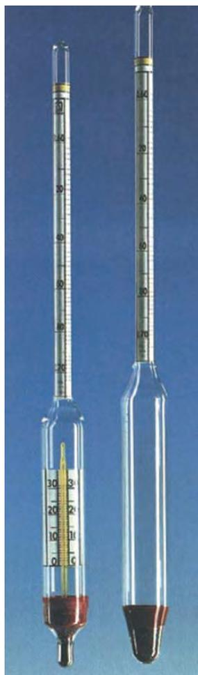
Per liquidi non trasparenti la lettura si effettua "da sopra". Controllare la temperatura del liquido immediatamente dopo la lettura. La temperatura massima ammessa per misurazioni con densimetri senza termometro è di 70°C.
