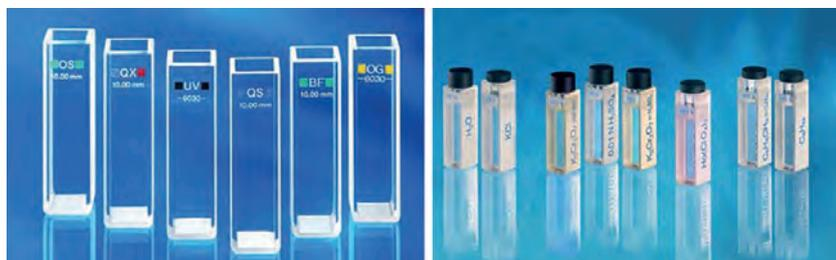
Ciascuno Standard e' costituito da una soluzione, di diversa tipologia in funzione del parametro verificato, contenuta in una cuvetta HELLMMA ad alta precisione, eseguita in quarzo SUPRASIL®.
