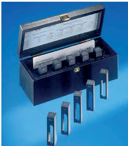
Ciascuno Standard è costituito da un supporto in alluminio anodizzato delle stesse dimensioni delle cuvette standard, all'interno del quale è montato un filtro di vetro drogato (filtri solidi). Nell'utilizzo, dovrà essere semplicemente inserito nel portacuvette dello spettrofotometro.
