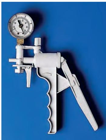
In polistirolo antiurto, leggera e portatile. E' possibile ottenere un vuoto fino a 625 mm Hg. E' in grado di produrre una pressione positiva per il trasferimento di liquidi mediante ripetute chiusure della leva. La quantità aspirata per ogni corsa del pistone è di ml 15. Attacco standard per tubi con diametro interno di 1/4".
