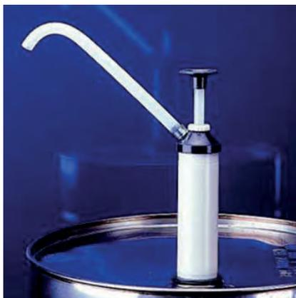
Pistone in polipropilene e polietilene. La pompa può essere fissata su contenitori con diametro interno della filettatura da 2" o ¾. La testa è in grado di ruotare a 360° consentendo di posizionare sulla superficie del fusto il bicchiere o il contenitore da riempire. Non indicata per il travaso di liquidi particolarmente corrosivi. La lunghezza del tubo di aspirazione è di mm 840.
