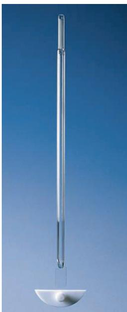
Agitatore a siringa in vetro borosilicato. Il modello completo è costituito da un'asta di agitazione e da una guida intercambiabile in vetro a tenuta di vuoto. La smerigliatura normalizzata SN 29/32 del raccordo, permette l'adattamento su palloni. Asta con paletta a forma di mezzaluna in PTFE, lunghezza totale dell'asta mm 420, diametro massimo della paletta mm 50, diametro asta per connessione mm 10.
