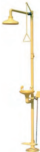
Doccia con lavaocchi. Comando della doccia con tirante. Il lavaocchi può funzionare sia per mezzo della barra antipanico che del comando a pedale posto sulla base. Vaschetta in ABS.
