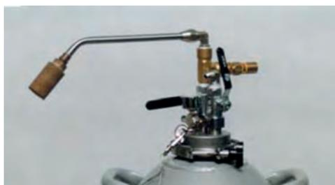
Contenitori ad elevata autonomia per il trasporto e la conservazione dell'azoto liquido. Costruzione in alluminio con doppia parete isolante provvista di comode maniglie per il trasporto. Tappo e collo del contenitore garantiscono un'ottima chiusura con minime perdite di azoto.
