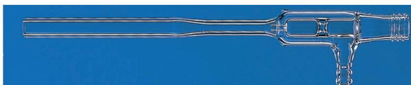
In vetro borosilicato Duran. Raccordo filettato GL18 per attacco rubinetto acqua. Raccordo laterale con strozzatura portagomma diametro mm 11. Prestazioni con pressione dell'acqua a 4,5 bar assoluto a 12°C. Consumo d'acqua ca. 340 l/ora. Pressione massima 16 mbar. La capacità di aspirazione è di ca. 950 l/ora di aria a pressione atmosferica.
