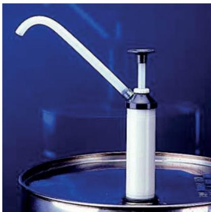
Pistone in polipropilene e polietilene. La pompa può essere fissata su contenitori con diametro interno della filettatura da 2" o 3/4. La testa è in grado di ruotare a 360° consentendo di posizionare sulla superficie del fusto il bicchiere o il contenitore da riempire. Non indicata per il travaso di liquidi particolarmente corrosivi. La lunghezza del tubo di aspirazione è di mm 840.
