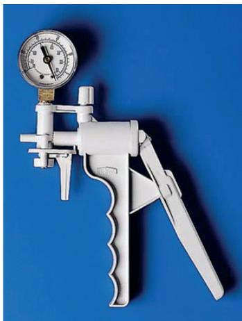
In polistirolo antiurto, leggera e portatile. È possibile ottenere un vuoto fino a 625 mm Hg. È in grado di produrre una pressione positiva per il trasferimento di liquidi mediante ripetute chiusure della leva. La quantità aspirata per ogni corsa del pistone è di ml 15. Attacco standard per tubi con diametro interno di 1/4".
