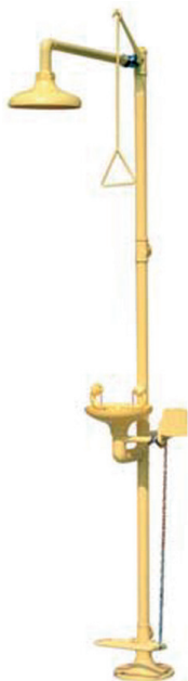
Doccia con lavaocchi. Comando della doccia con tirante. Il lavaocchi può funzionare sia per mezzo della barra antipanico che del comando a pedale posto sulla base. Vaschetta in ABS.
