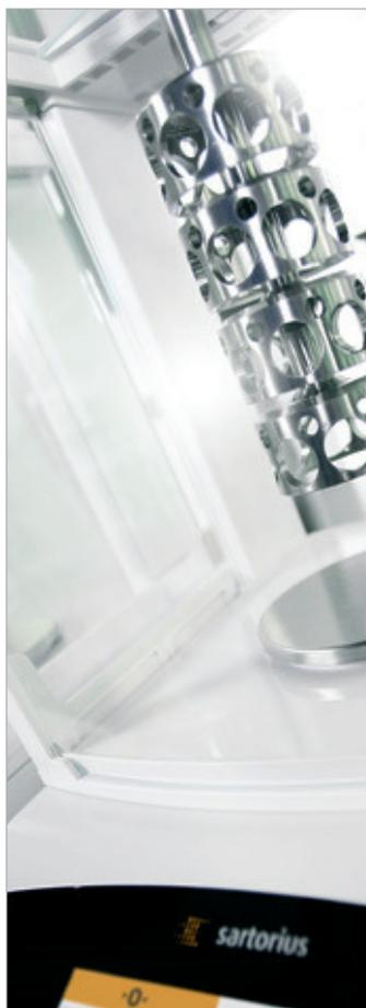
La linearità è ancora corretta anche dopo 1 milione di cicli? Assolutamente! In figura la Quintix® sottoposta ad un test di resistenza
